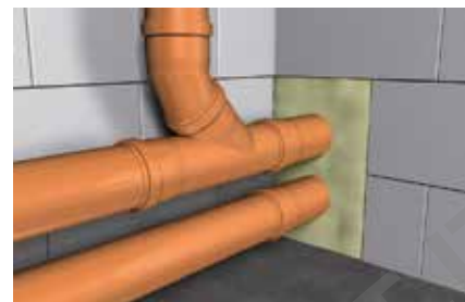
Riempimento di attraversamenti di tubazioni
